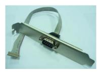
1 x 10-pin DF14 to D-sub 9 Cable(MP-6816D4) 2 x 10-pin DF14 to D-sub 9 Cable(MP-6816D8) (OALES-BKU1-H14)
